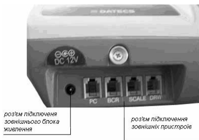
Рисунок 2 – Розташування роз'ємів для підключення блоку живлення та зовнішніх пристроїв
