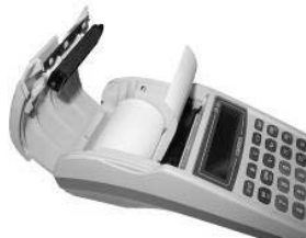
Рисунок 4 – Місце установлення паперової стрічки
