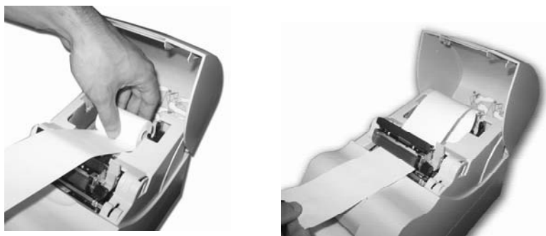
Слика 5.3.2 Постављање папирне ролне извјештаја
