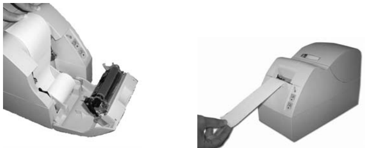
Слика 5.3.1 Постављање папирне ролне исјечка
