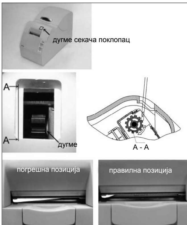
Слика 5.6.1 Отклањање грешке на ауто сјекачу
